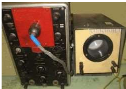
Осциллограф с вынесенной ЭЛТ, помещенной в соленоид
