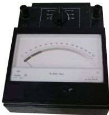
вольтметр М2004 сопротивление неизвестно
