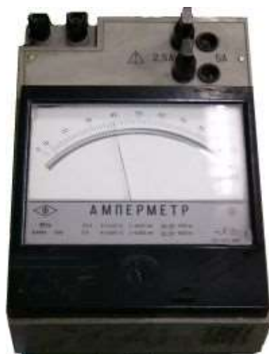
амперметр Э514 I_{\max}=2,5 \text{ A} , R_A=0,012 \text{ Ом} I_{\max}=5,0 \text{ A} , R_A=0,005 \text{ Ом}
