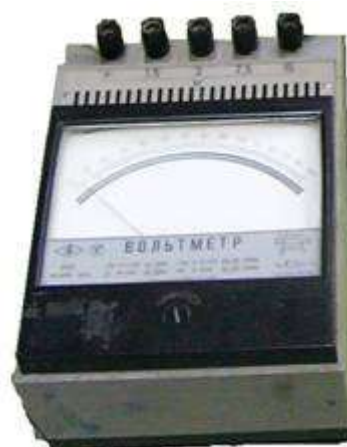
вольтметр Э515 U_{\max}=1,5 \text{ В} , R_V=7,5 \text{ Ом} U_{\max}=3,0 \text{ В} , R_V=15,0 \text{ Ом} U_{\max}=7,5 \text{ В} , R_V=37,5 \text{ Ом} U_{\max}=15 \text{ В} , R_V=75,0 \text{ Ом}
