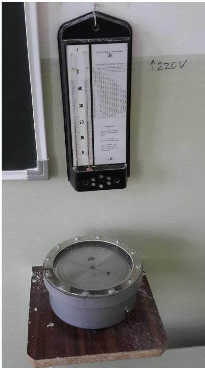
Рис. 3. Приборы для определения комнатной температуры и атмосферного давления
