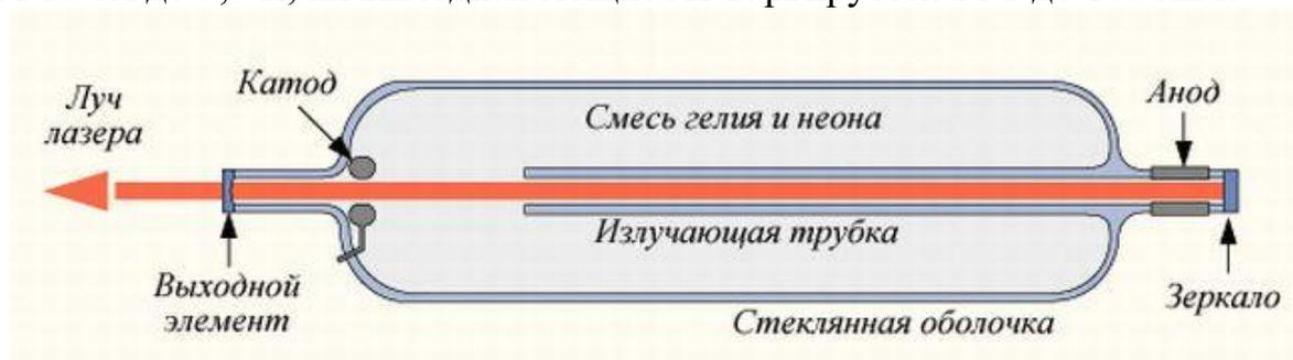
Рис. 7.3. Устройство гелий-неонового лазера
