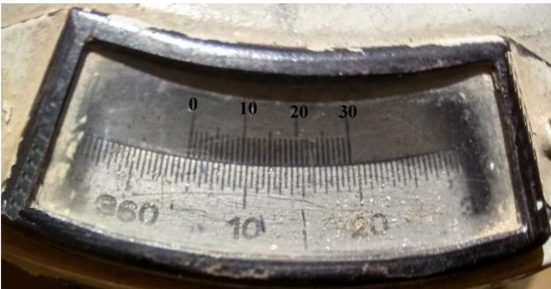
Рис. 6.6. Вид и пример отсчёта по нониусу гониометра
