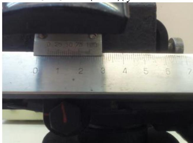
Рис. 5М.4. Фото отсчётного устройства
