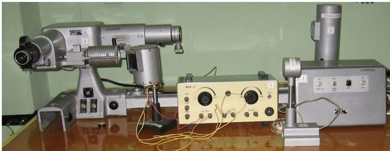
Для определения длин волн спектральных линий в работе используется универсальный монохроматор УМ-2, предназначенный для спектральных исследований излучения в диапазоне длин волн 380-1000 нм. Разработан в начале 50-х годов. Прибор оказался настолько удачным, что до сих пор серийно выпускается нашей промышленностью.
