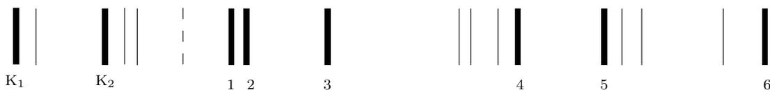
Рис. 4. Спектр ртутной лампы ДРШ
