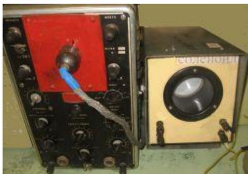
осциллограф с вынесенной ЭЛТ,
